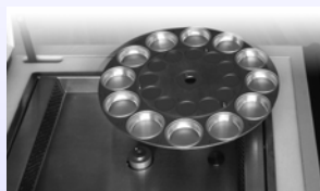
Abb. 4: Der Probenteller kann zur einfacheren Handhabung komplett entnommen werden. Der Innenraum der Prüfkammer ist glattflächig und leicht zu reinigen
