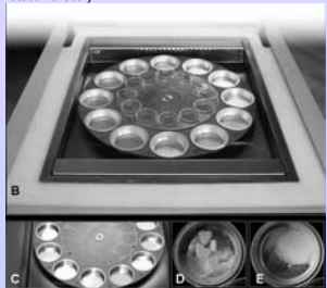
Abb. 3: Feuchtesorptionsprüfergerät SPS11. B: offener Probenraum mit Probenteller mit Probenschalen aus Aluminium (Wägeposition, außerer Kreis) und kleineren Schalen aus Kunststoff (innerer Kreis des Probentellers) für nicht gewogene, während des Messzyklus entfernbare Proben; C: Probenteller ohne Kunststoffschälchen; D und E: Beladene Probenschalen.
